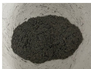
Rys. 4. Produkt mielenia w młynie nożowym Pulverisette 25 Fig. 4. Product ground in a Pulverisette 25 knife mill
