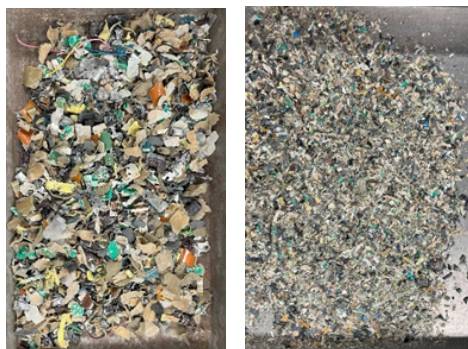
Fig. 3. Products of two-stage comminution in a hammer crusher Rys. 3. Produkty dwustopniowego rozdrabniania w kruszarce młotkowej
