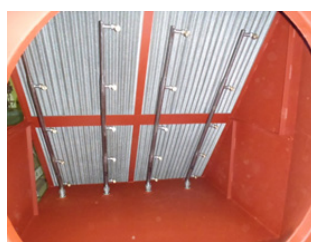
Rys. 2. Budowa wewnętrzna odpylacza mokrego typoszeregu HCN [7]
