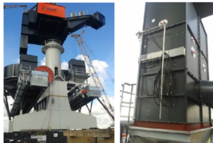
Rys. 11. Zastosowanie instalacji odpylającej na portowej stacji rozładunkowej węgla w porcie w Rydze (CFT Polska, 2024) Fig. 11. Application of dust removal installation at the port coal unloading station in the port of Riga (CFT Polska, 2024)
