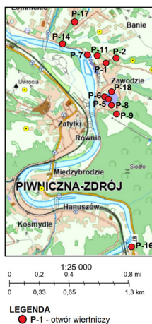
Rys. 2. Lokalizacja otworów wiertniczych w rejonie Piwnicznej-Zdroju
