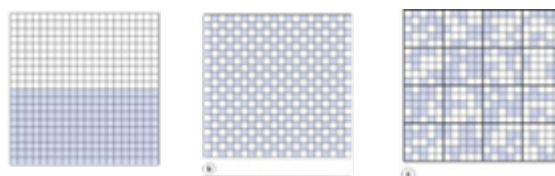
Rys. 1. Przedstawienie graficzne procesu mieszania (a) segregacja początkowa, (b) mieszanie idealne, (c) losowe mieszanie Fig. 1. Graphical representation of the mixing process (a) initial segregation, (b) ideal mixing, (c) random mixing
